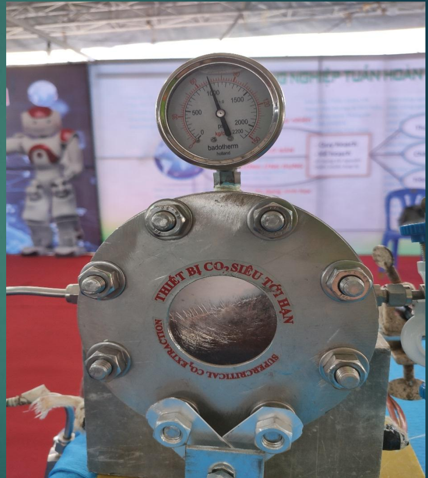
Mô hình chiết xuất bằng CO 2 siêu tới hạn ở quy mô phòng thí nghiệm
